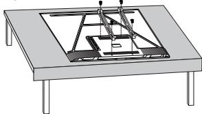
Atornille firmemente el soporte VESA en la cubierta posterior con 4 tornillos VESA.
